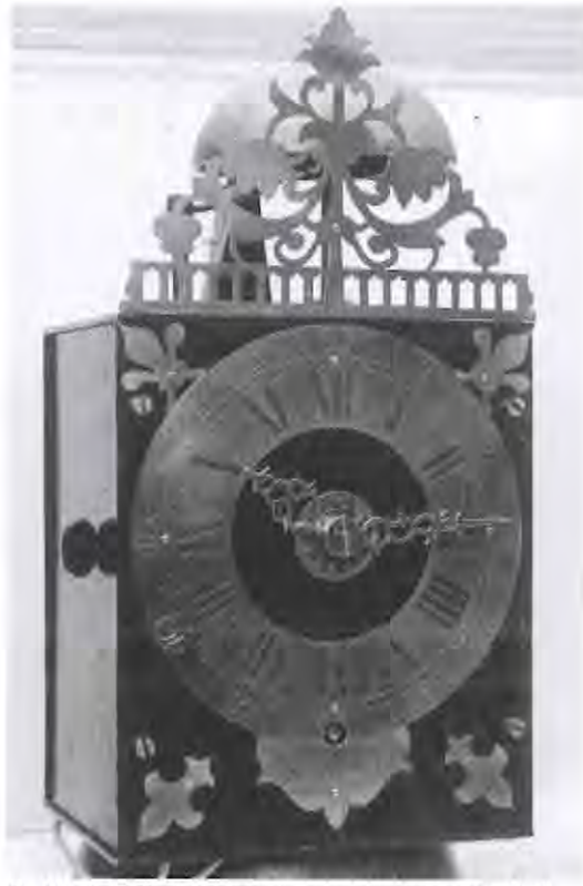
2. Morbierwekker met zeer dunne massief zilveren cijferrand. Let op de kleine draatbare afsluiter voor het opwindgat.
