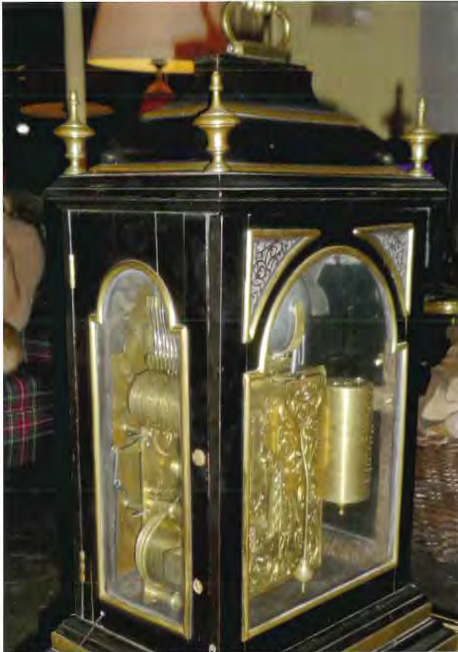
20. Verwisselbare cilinder van Klinkenberg. Bij speelwerken met verwisselbare cilinders was het aantal melodieën dat kon worden gespeeld veel groter.
