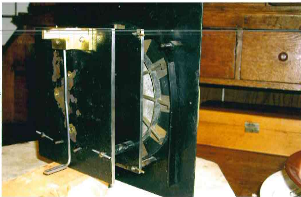
Foto 2 – Het uurwerk is van eenvoudige constructie met zeer zware platinen
