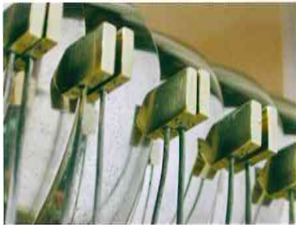
8. Dubbele hamertjes bij Andriesse Meerdere hamertjes op één bel bieden de mogelijkheid voor toepassing van snel repeterende nootjes
