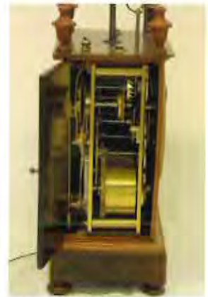
B.5. Aan de linkerzijde is o.a. het wekkerwerk met trekkoord zichtbaar.
