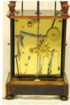
B.4. Achterzijde van het uurwerk met laag in de kast hangende slinger.
