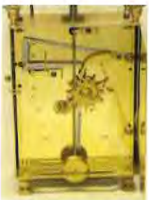
C.3. Achterzijde. Ook hier hangt de slinger laag, zo laag dat er een uitsparing in de bodem van het kastje nodig is.
