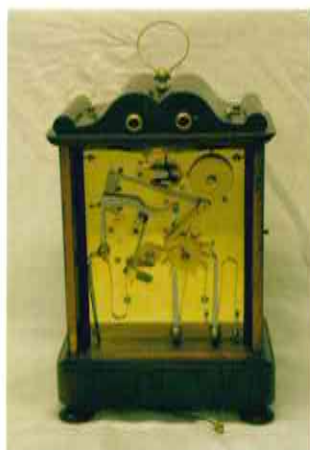
A.3. Achterzijde van het uurwerk met aan de bovenkant het cilinder echappement.
