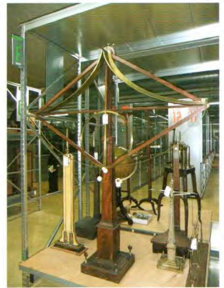
Foto 2 - Demonstratiemodel van slingerwetten met cycloïdebogen van Huygens. Het model is manshoog en is duidelijk bedoeld voor demonstratie in een collegezaal. Er zijn drie balletjes opgehangen aan touwtjes. Eén balletje waarvan het touwtje tegen de cycloïdebogen aankomt. Een tweede balletje waarvan het touwtje even lang is, maar niet tegen de cycloïdebogen aankomt. Het touwtje van het derde balletje is duidelijk langer.
