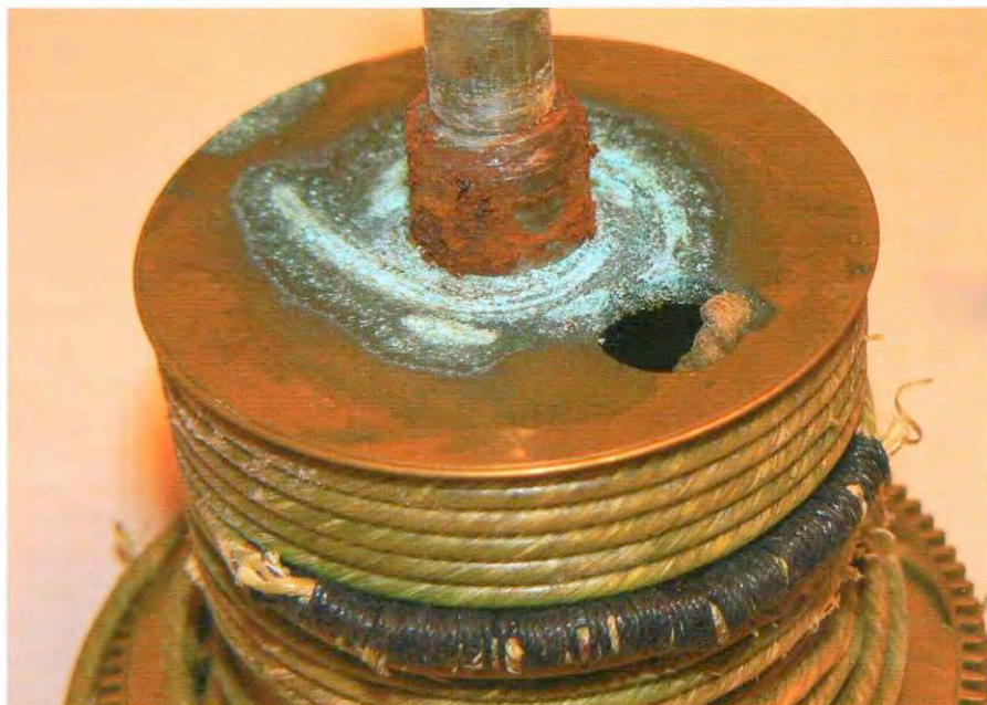
Afb. 2 - Roest blokkeert het slagwerk van de scheepjesklok.
