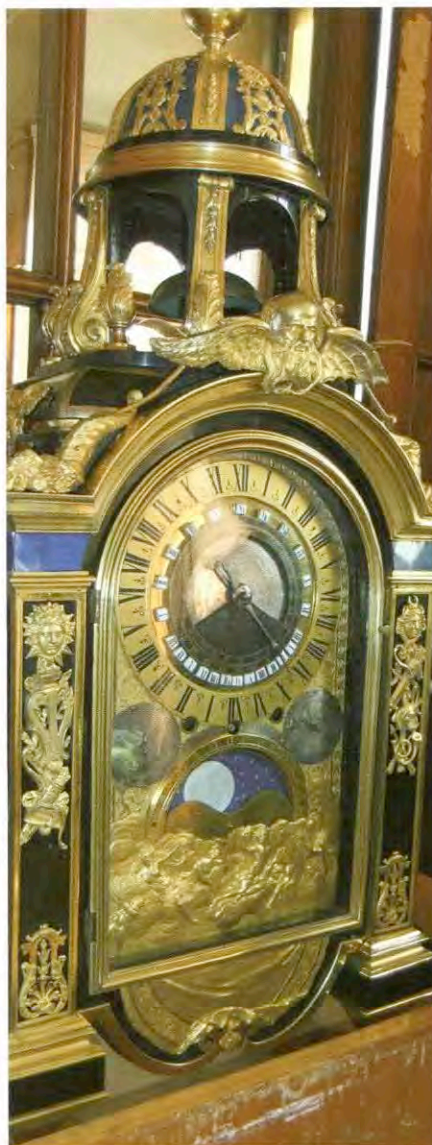
Foto 6 - Astronomisch uurwerk van Fardoll 1710, in het Observatoire de Paris. Hoofdwijzerplaat met twee maal 12 uur aanduiding. Aan de binnenzijde van de hoofdwijzerplaat is een verdeling met wit geëmailleerde cartouches die verschoven kunnen worden: de tijden tussen zons-opgang en -ondergang worden beide in 12 uren onderverdeeld.
