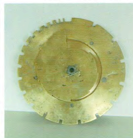
Foto 7 - Sluitschijf en traprad vormen één geheel
