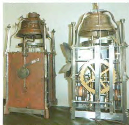
Afb. 5 - Achterzijde van beide klokken. Op de klok van Crijns is het wekkerwerk aan de achterzijde bevestigd en de windvleugel binnen het frame. De Barentsz-klok heeft de wekker links binnenin en de windvleugel rechts buiten.
