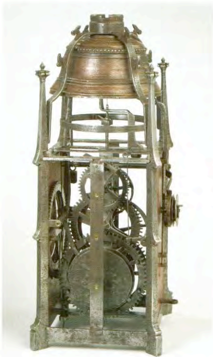
Afb. 7 - Gotische klok, rechter zijkant. Met het trekarmpje kan het slagwerk gelijk gezet worden. De onderdelen van het frame zijn verbonden met constructies uit de houtbouw (waaronder zwaluwstaarten en half zwaluwstaarten) en vast gezet met keggen.
