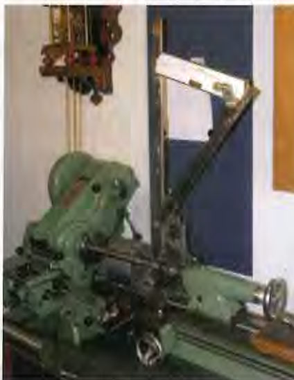
Foto 5 – Het bijzondere verdeelapparaat voor het snijden van het grote tandwiel
