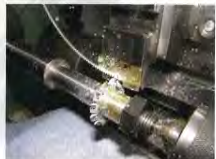
Foto 6 – Detailopname van het snijden van het grote tandwiel
