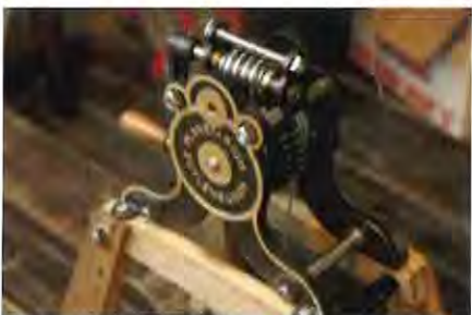
Afb. 11 - Zo wordt het gewicht opgetrokken, dat het geheel aandrijft
