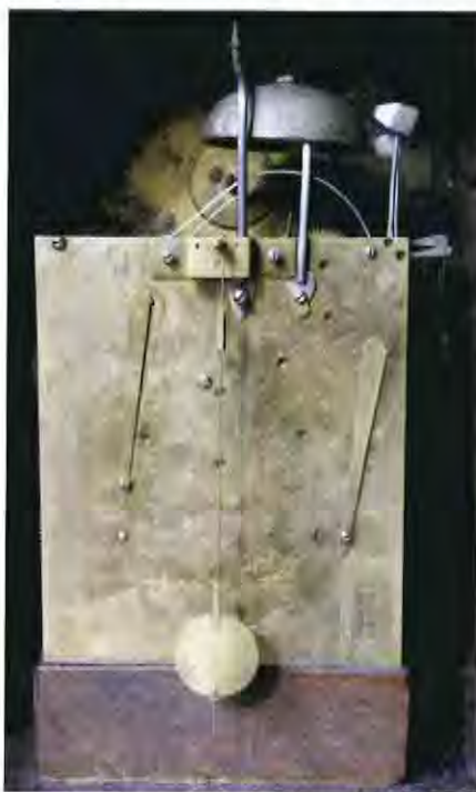
Afb 7. Gegraveerde achterplatine. Een bel is gedemonteerd. De slinger hangt aan een touwtje.
