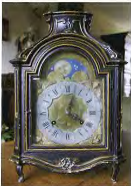
◀ Afb 8. Ter vergelijking deze tafelklok van Jacobus Joosten uit Maaseik, die ons doet denken aan de tafelklok van De Neve. Het kastje is echter wat lichtvoetiger en van gouden biesjes voorzien. De wijzerplaat is van tin en de hoekversieringen bestaan uit vier engeltjes. Dit uurwerk bevindt zich evenals het uurwerk van De Neve tussen dikke messing platines, heeft hetzelfde slagwerk met slaghamers, is voorzien van maandstand en datumaanduiding, gelakte wijzers, twee bellen en heeft een korte slinger, opgehangen aan een touwtje. De gaten in het dak van beide kasten geven aanleiding te veronderstellen dat ze een bekroning hebben gehad, in welke vorm dan ook. Tafelklokjes in de regio Limburg zijn zeldzaam te noemen, vandaar dat ik deze ter vergelijking heb toegevoegd.
