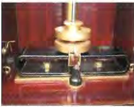
Afb. 4 - De spoel beweegt over de permanente magneten.
