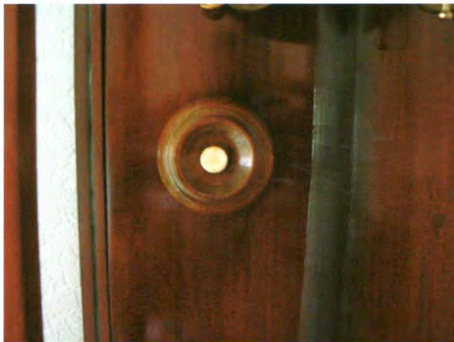
In de kast bevindt zich een knop die bij indrukken na stoomuitval een veer optwindt en zo voor de nodige gangreserve zorgt.
