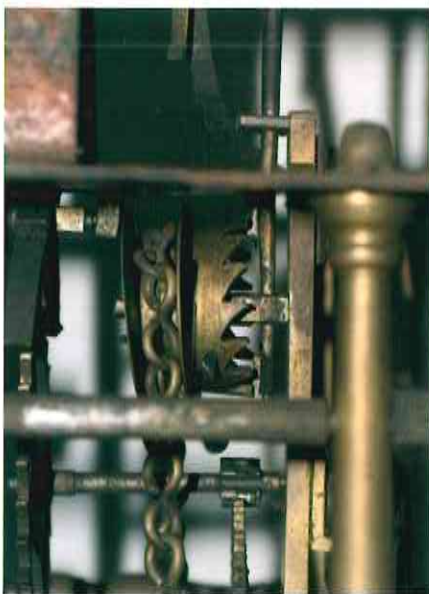
Detail van Gronuster uurwerk waarbij nog wat van de gladde pilaren te zien is, evenals het anker onder de zolderplaat. Uitlichting wekker- werk aan bovenzijde tussen de pilaar. (Uurwerk Douwe Jelles Tasma).
