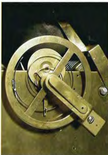
Afb. 14/3 detail balans op achterplatine
