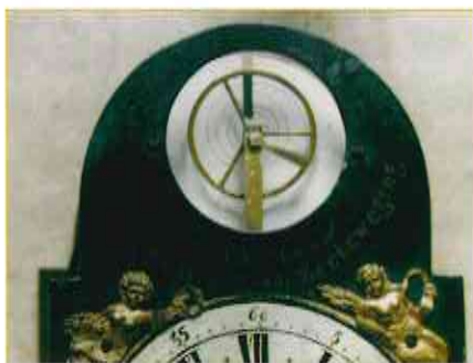
Afb. T13* Zichtbare balans in staartschippertje gesigneerd: L.D. Tasma
