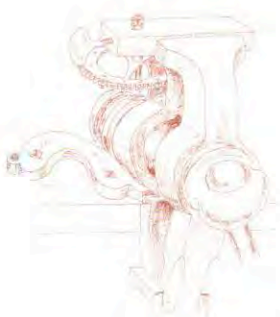
Het inspannen van het pennenrad om het rondsel in te snijden
