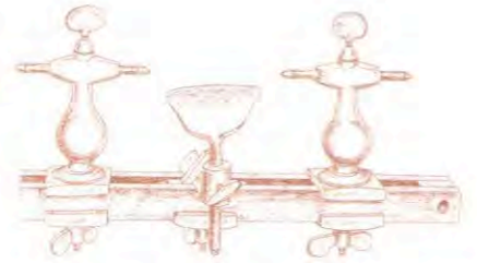
Draaibank ijzer en messing centerhoogte 11,5 cm, max. opname ±36 cm
