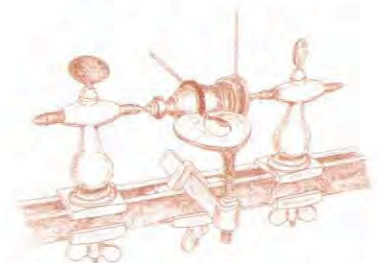
De zaag en de sagetisch (zaagtafeltje) op de draaibank gemonteerd. De zaag is tussen houten schijven geklemd op een vierkante as, die van centerpunten is voorzien
