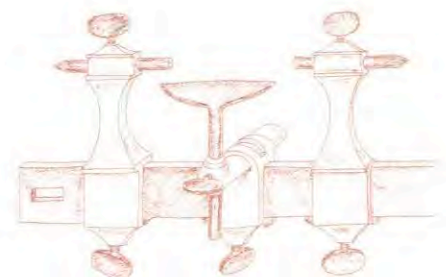
Draaibank ijzer en messing centerhoogte 7 cm, max. opname 28 cm
