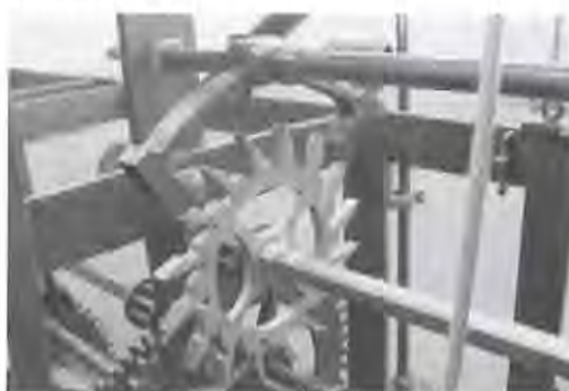
Bij punt 1. Een speciaal gevormd ankerrad
