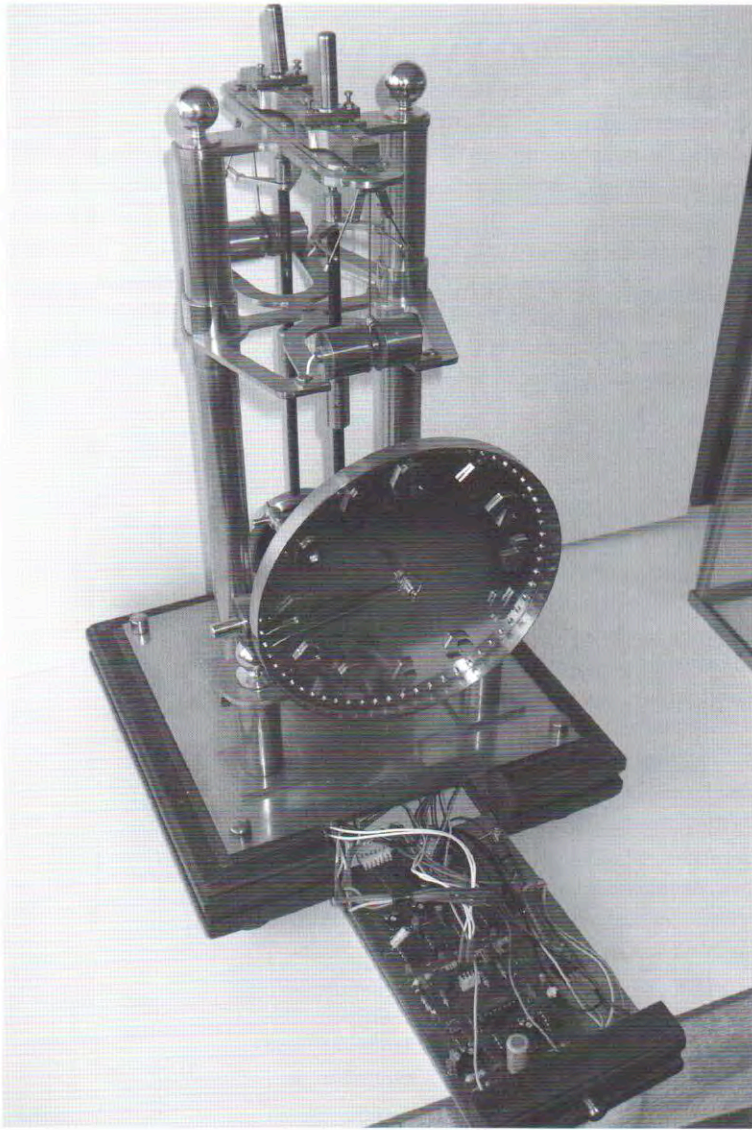
Afb. 5. Electronische uurwerken zijn weer een andere vorm van zelfbouw. Op de foto is de electronica 'tentoon gesteld', normaal zit deze netjes opgeborgen in een lade on de voet van de klok. (foto: J. Pool)
