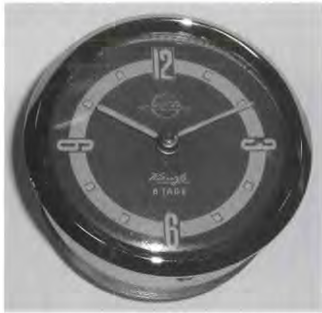
Afb. 12. Kienzle opwindklok met een loopduur van acht dagen voor Opel.
