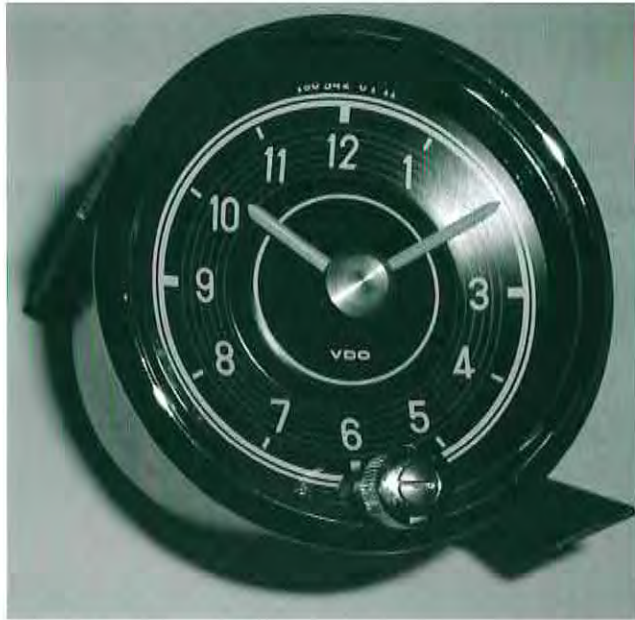
Afb. 9. Klokje met 60 mm diameter voor Mercedes modellen uit de jaren zestig en zeventig.
