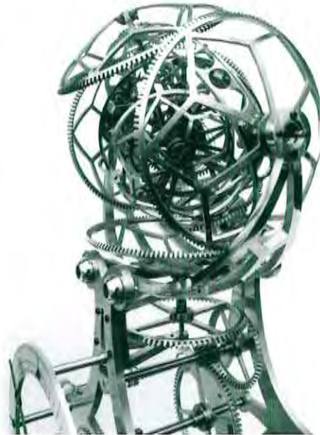
Afb. 3 Detail opname van het drie-assig tourbillon met gelagerde bolvormige tandwielen.
