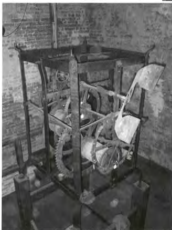
Afb. 2 Het (toren)uurwerk is van smeedijzer en bezit een (later aangebrachte) pennengang met slinger.
