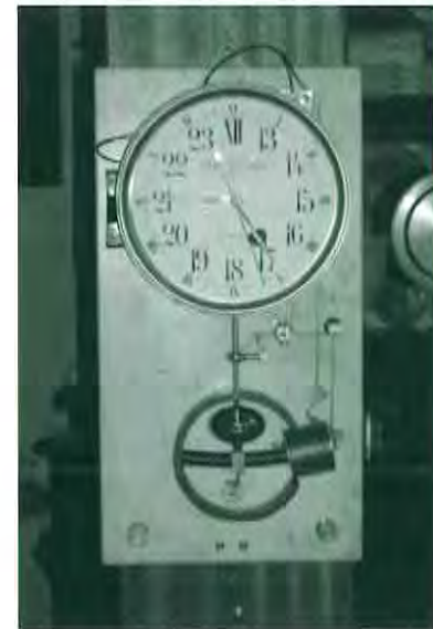
Afb. 4 Franse elektrische moederklok op marmeren plaat gemaakt door de Ateliers Vaucanson in Parijs.
