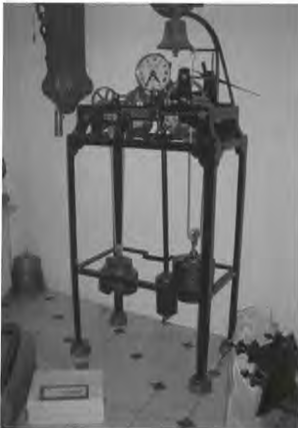
Afb. 7 Flatbed torenuurwerk van Smith uit Derby.
