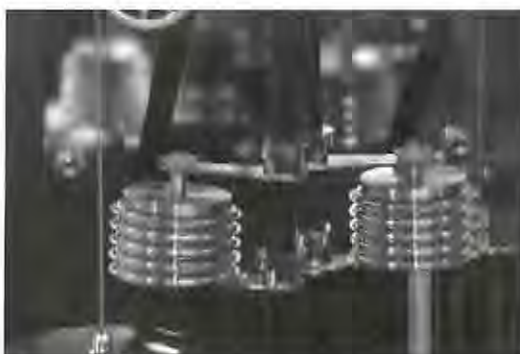
Afb. 3 Balgen voor barometrische compensatie.
