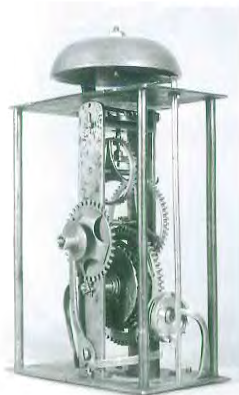
Afb. 2 Uurwerk van een Gruyère-klokje met wekker, gesignd: "Simon Doutaz 1780", B x H x D = 12,3 x 21,5 x 7 cm [1].
