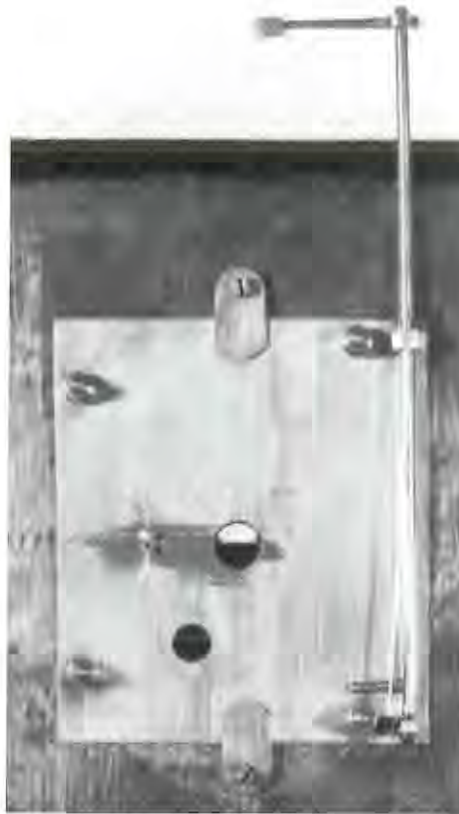
Afb. 7 Achterzijde van de houten wijzerplaat van de klok van Gilles Martinot (F1) met de extra plaat en de aandrijving van de bel.
