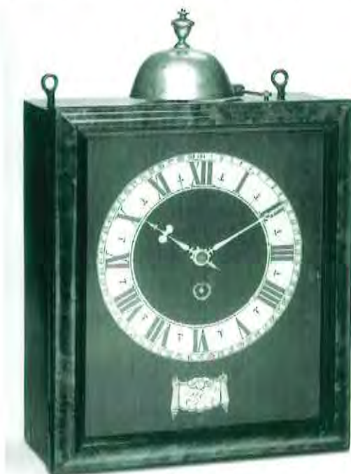
Afb. 8 Klok met gaand en slagwerk van Nicolas Hanet (F5).[2], blz. 45.
