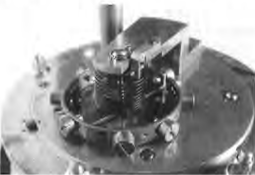
Afb. 3 Detail balans met balansveer, zoals aangebracht door Arnold en Dent.
