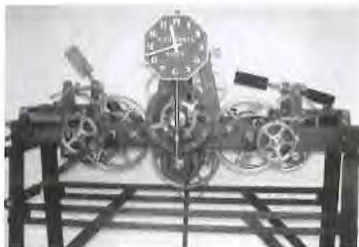
Afb. 1 Groot Eijsbouts-torenuurwerk uit 1921, fabricagenr. 732. Het uurwerk heeft gaand werk, uurslag en kwartierslag met speelwerk. In werking geweest tot ongeveer 1972.
