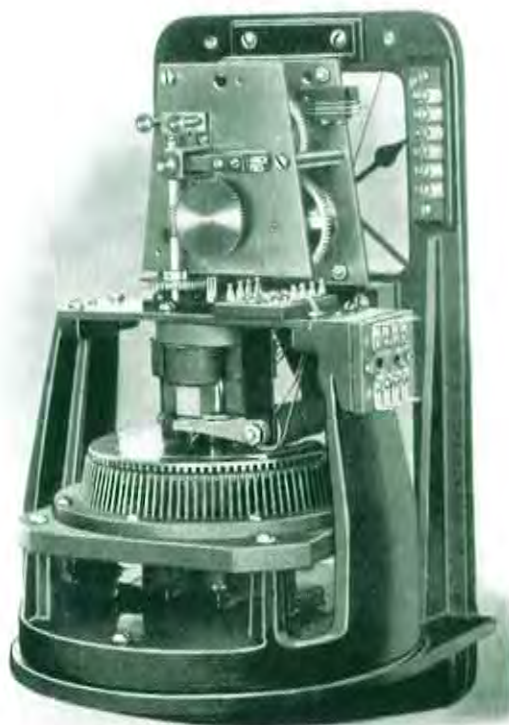
Afb. 4 1000Hz synchroonmotor met raderwerk naar de klok
