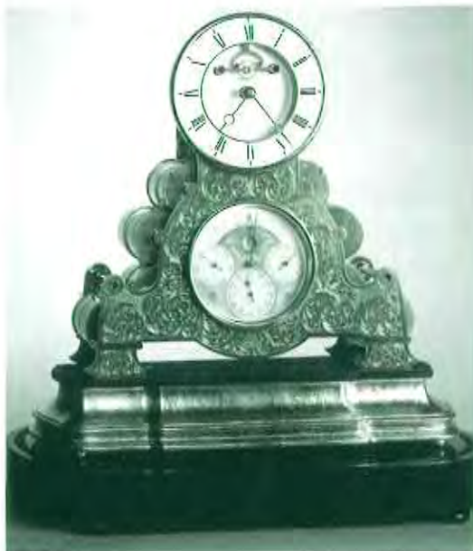
afb. 7 Pendule van Brocot met volle- dig kalendarium en tijdvereffe- ning. Gangduur vier jaar!
