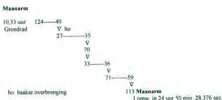
Afb. 12 De tandwieltrain voor de aandrijving van de maanarm.
