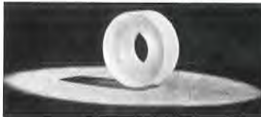
Afb. 1 100.000 Hz kristal met lage tempera- tuurcoëfficiënt
