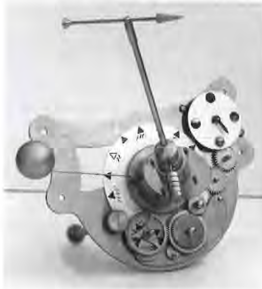
Afb. 14 De bovenplatinen. Rechtsboven de indicator van de maanfase. De vijf tandwielen onderaan maken deel uit van de aandrijving van de maanarm.
