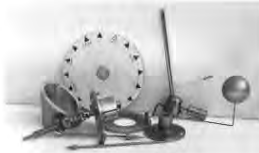
Afb. 13 Delen van het zon- en maanaanwijssysteem. De "pijl" op de voorgrond dient om de sokkel op het noorden uit te richten. Deze wordt hiertoe in een aan de "noordzijde" van de sokkel aangebrachte opening gestoken.
