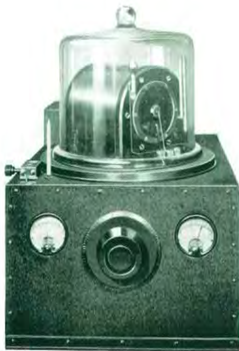
Afb. 3 Complete kristaloscillator met het gemonteerde kristal
