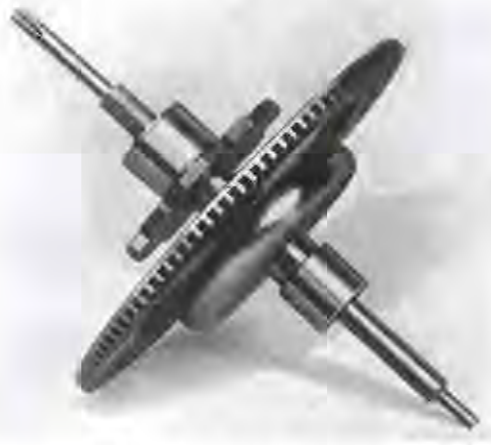
Afb. 5 De rotor van de 1000 toeren/min. motor
