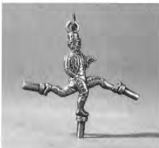
Afb. 8 Gegoten messing leutel met drie "opwindbenen".
