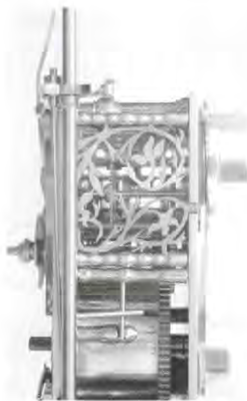
Afb. 8 (rechts) De stalen helgjes dienen zowel voor het vrijgeven als het stoppen van het stoprad.
