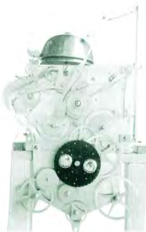
Afb. 10 Onderaan de voorplaat zijn de tandwiel- treinen ten behoeve van de aanwijzing van de maand, datum, dag van de week en maanfase gemonteerd.
