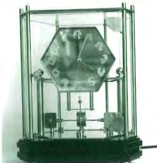
Afb. 1 (links) Het uurwerk met elektromagnetisch aangedreven foliot.
