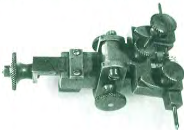
Afb. 2 Het gereedschapje voor het afwerken van een cilinderchappement.
