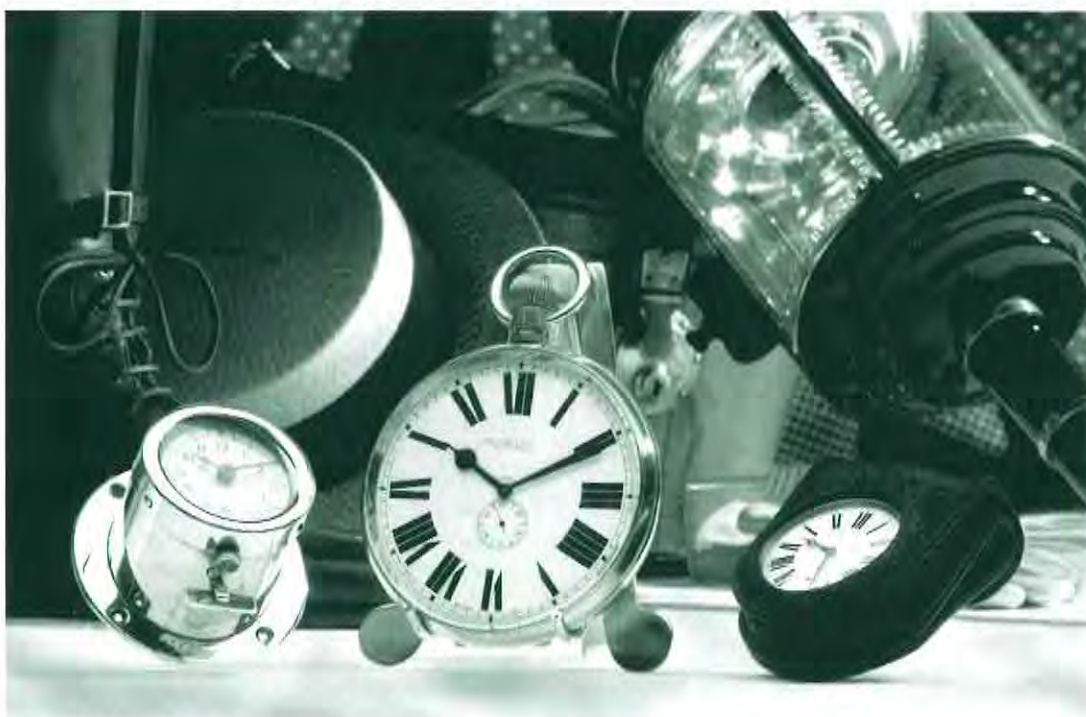
Afb. 1 links: Metalen schildklok voor bevestiging met schroeven op het schuine voorschild. midden: Rijtuighorloge om binnenin de koets op te hangen. rechts: In leren etui geval rijtuighorloge voor bevestiging op het voorschild. (foto: Rob Glastra, Schoonhoven)
