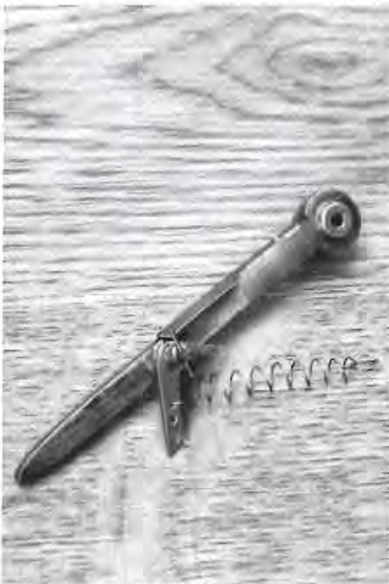
Foto 2 - De lichter van het repetitieslagwerk met het trekveertje.
