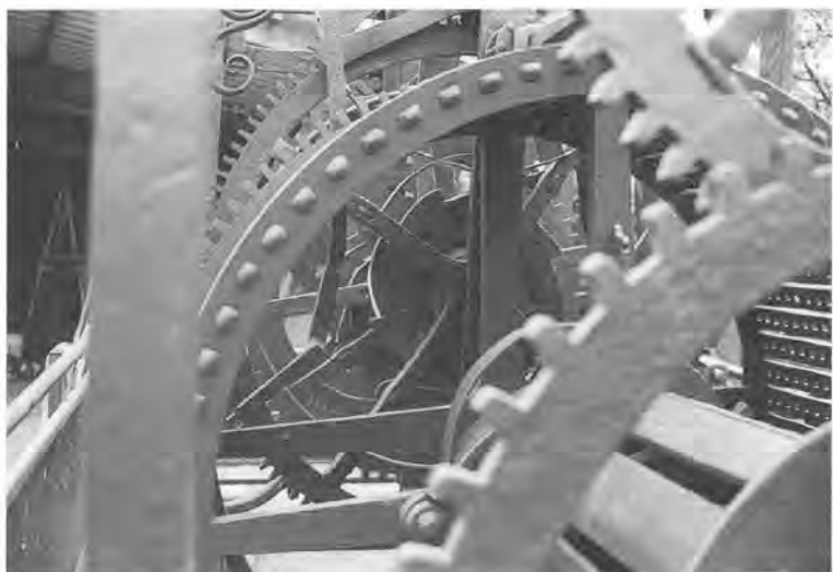
Foto 5 - Detail van de speeltrommel. Duidelijk zijn de geklonken uiteinden van de strippen zichtbaar.
