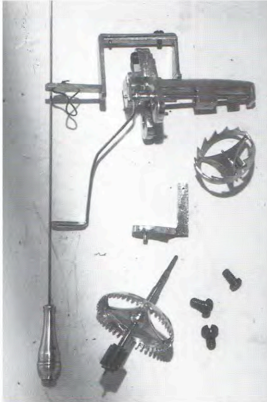
Fig. 5. - De nieuw vervaardigde onderdelen voor de spillegang en slinger.
